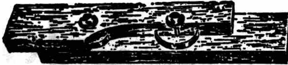
(a) Junta hecha con anillos partidos Se hizo un corte en uno de los miembros para mostrar la posición de los anillos
